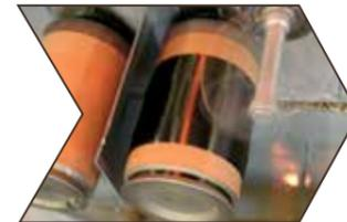
**1** Durch einen Trichter fallen die ca. 5 bis 10 cm großen Basaltsteine in den Schmelzofen. Im Inneren herrschen – gradgenau reguliert – Temperaturen zwischen 1.300°C und 1.450°C. Hier wird der Basalt plastifiziert, also aufgeschmolzen und flüssig gemacht.
