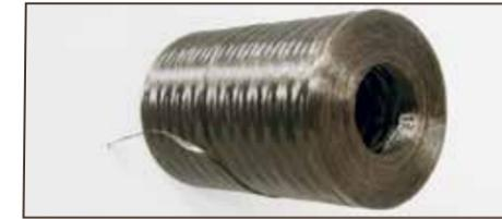
**ROVINGS:** Ein Elementarfaden besteht aus 250 Filamenten. Mehrere Elementarfäden werden als Garn gebündelt zu einem Roving aufgespult, das wiederum als Ausgangsmaterial für die textile Weiterverarbeitung dient. Rovings sind das Ausgangsmaterial fürs Zwirnen, Spinnen, Wirken oder Weben.
